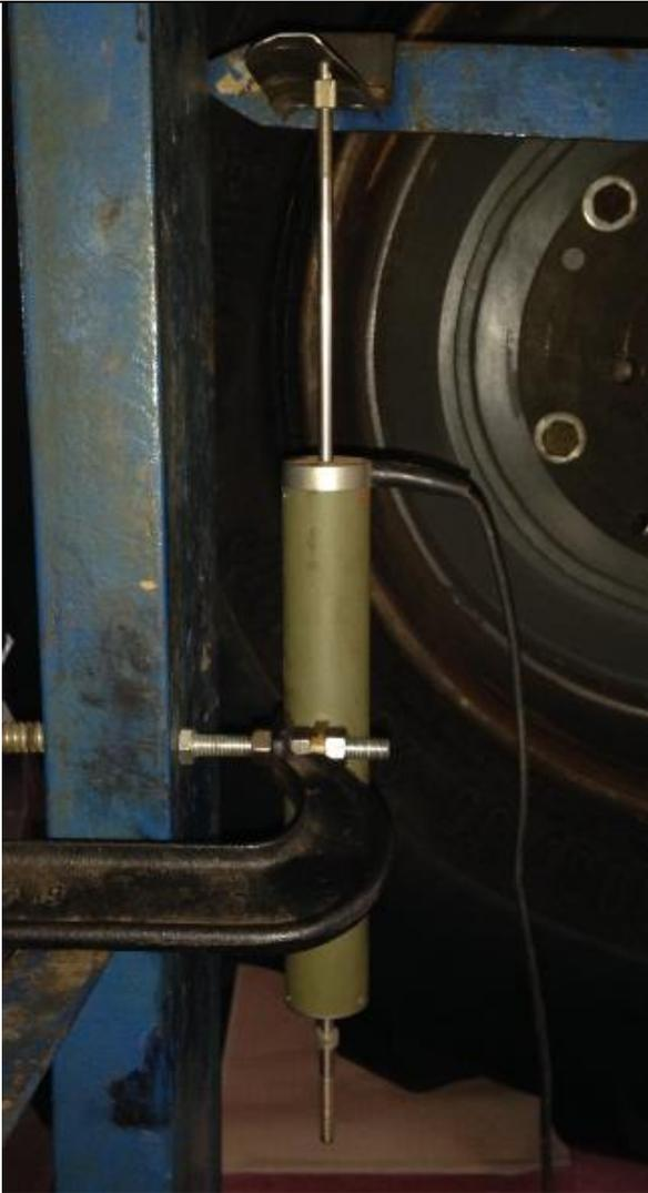
**Figura 3** - Aferição do deslocamento vertical pelo potenciômetro
