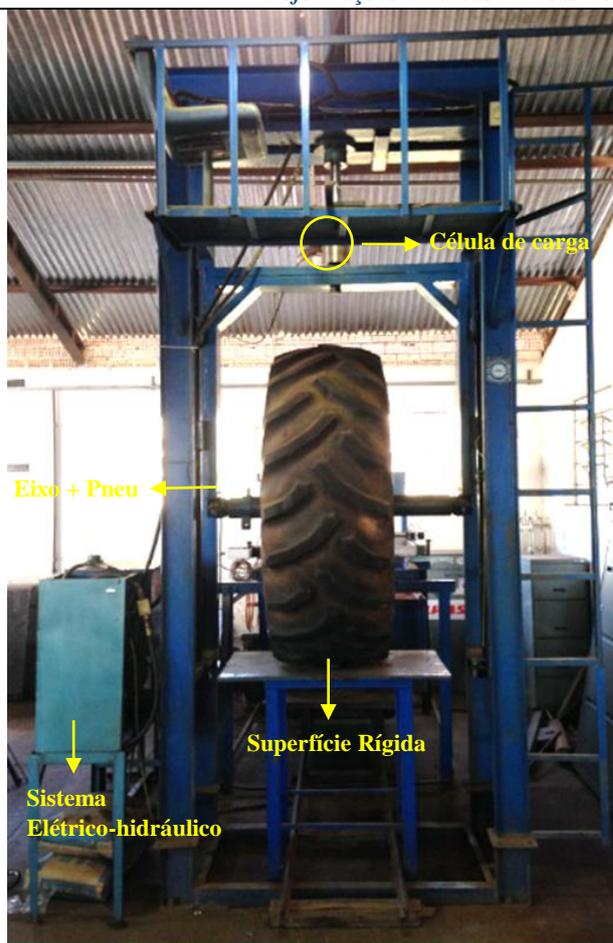
**Figura 1 - Prensa hidráulica e superfície rígida utilizada no ensaio de pneus**
