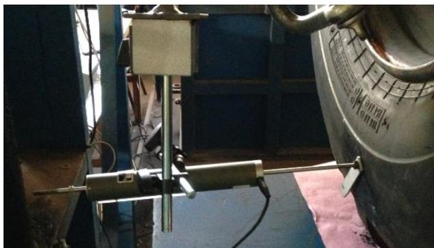
**Figura 2 – Aferição do deslocamento horizontal pelo potenciômetro**
