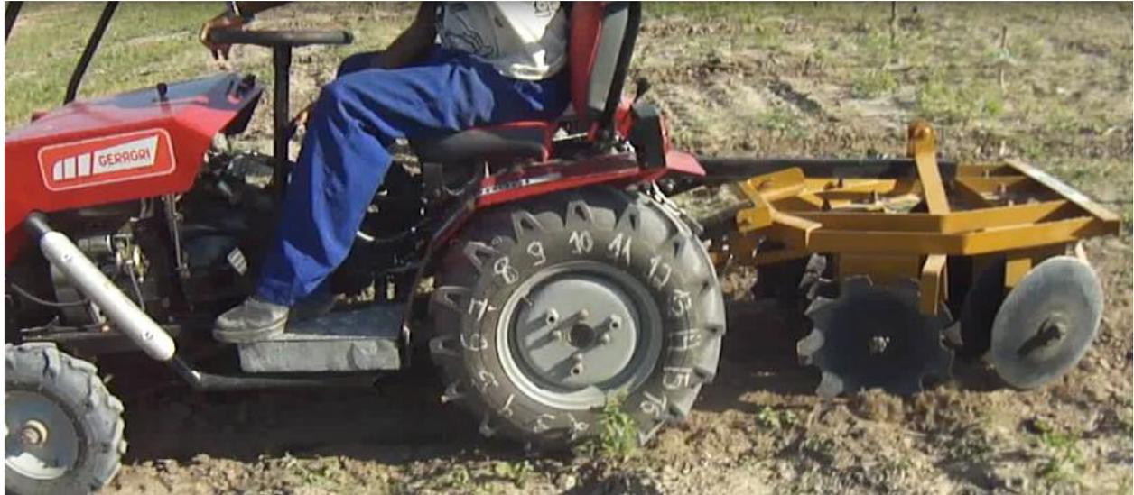
**Figura 1** - Vista lateral do quadriciclo agrícola equipado com a grade.
