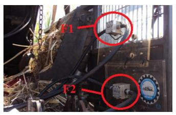
**Figura 1 -** Fluxômetro de entrada (F1) e retorno (F2) instalados na colhedora.
