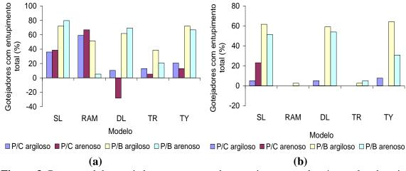
**Figura 3.** Percentual de gotejadores apresentando entupimento total após o pulso de sujeira na situação de emissor usado (a) e novo (b).
