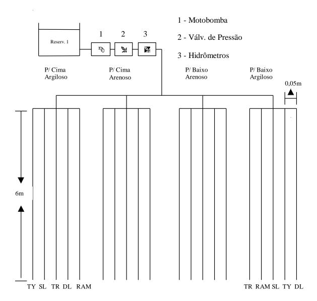
Figura 1. Desenho esquemático da bancada de ensaio
