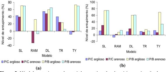
**Figura 2.** Nível de entupimento de gotejadores após pulso de sujeira na situação de emissor usado (a) e novo (b).
